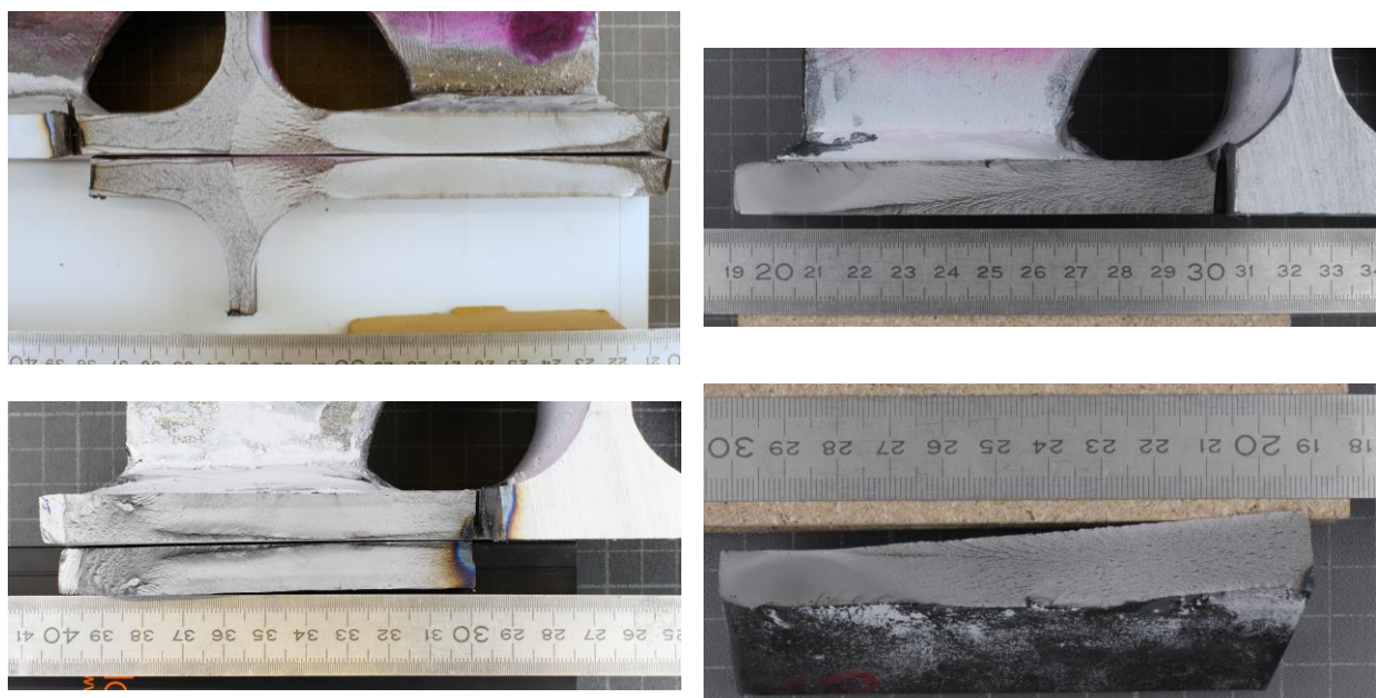
Abbildung 87: Bruchflächen der Probekörper 1-1 (oben links), 1-3 (rechts) und 1-4 (unten links)
