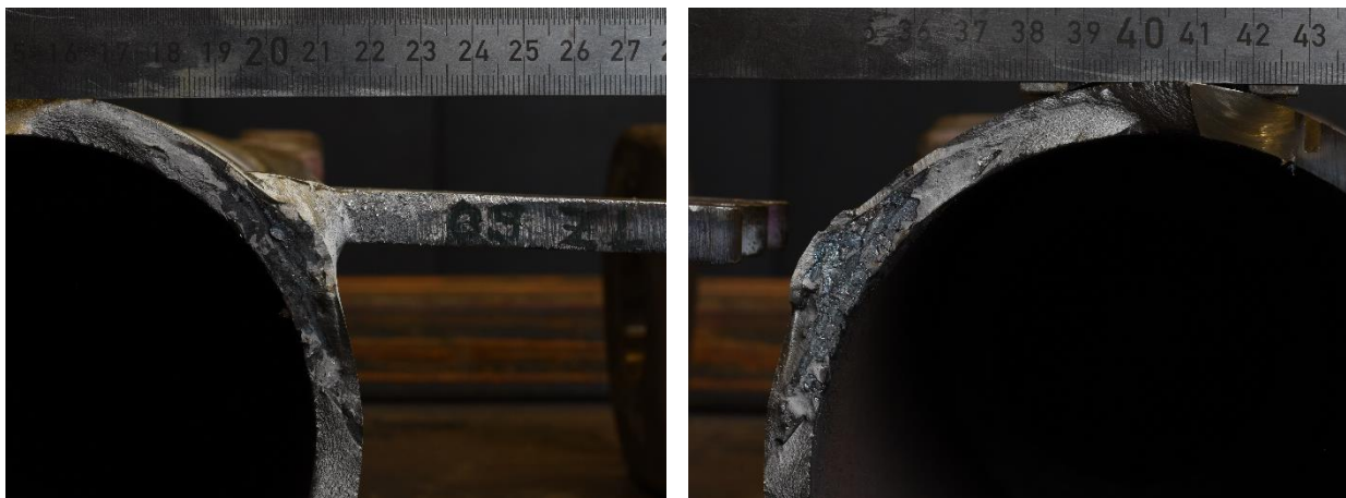
Abbildung 99: Bruchflächen des Großbauteils Typ 4, Probekörper AW09 im reparierten Zustand
