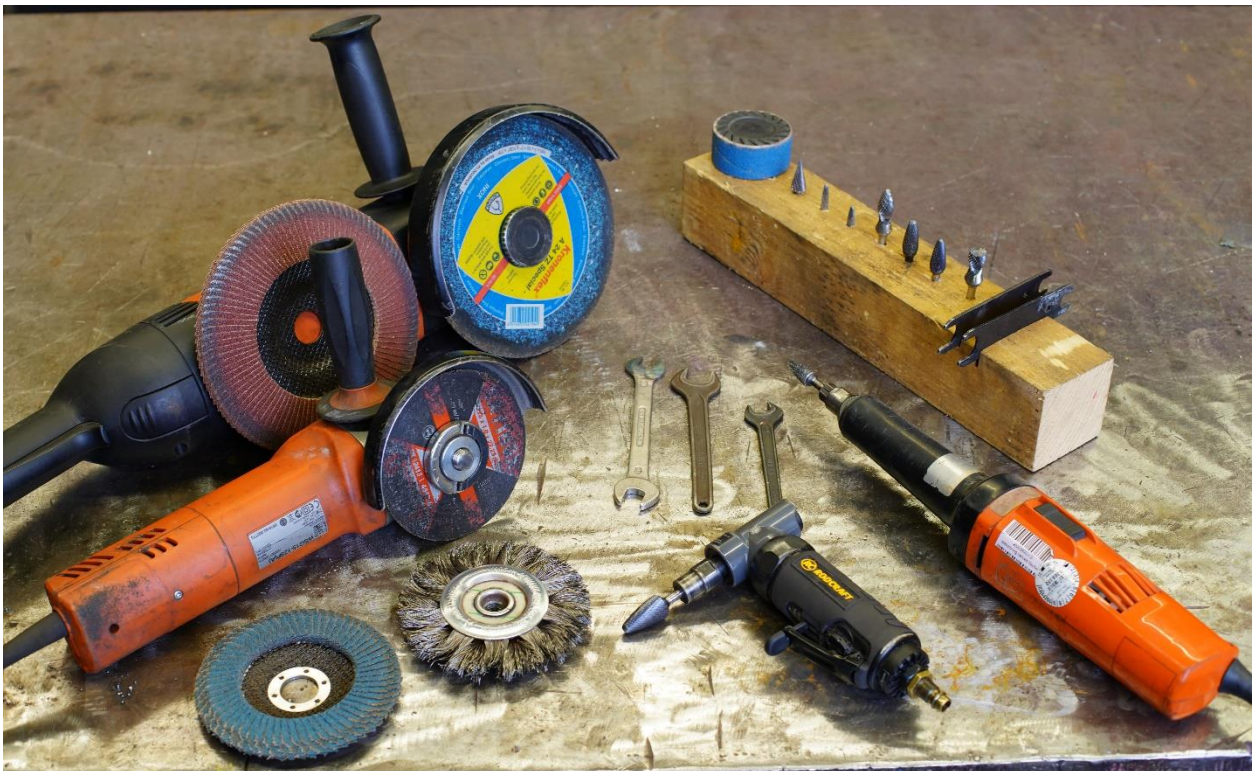
Abbildung 71: Für die Reparaturahtvorbereitung verwendete Schleifmittel
