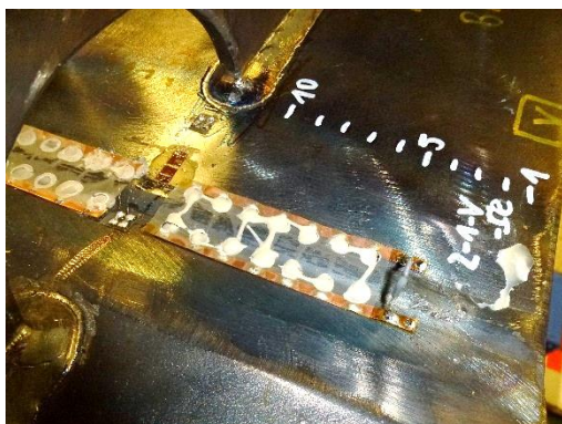
Abbildung 58: „Riss-DMS“ und im Messverstärker resultierendes Signal
