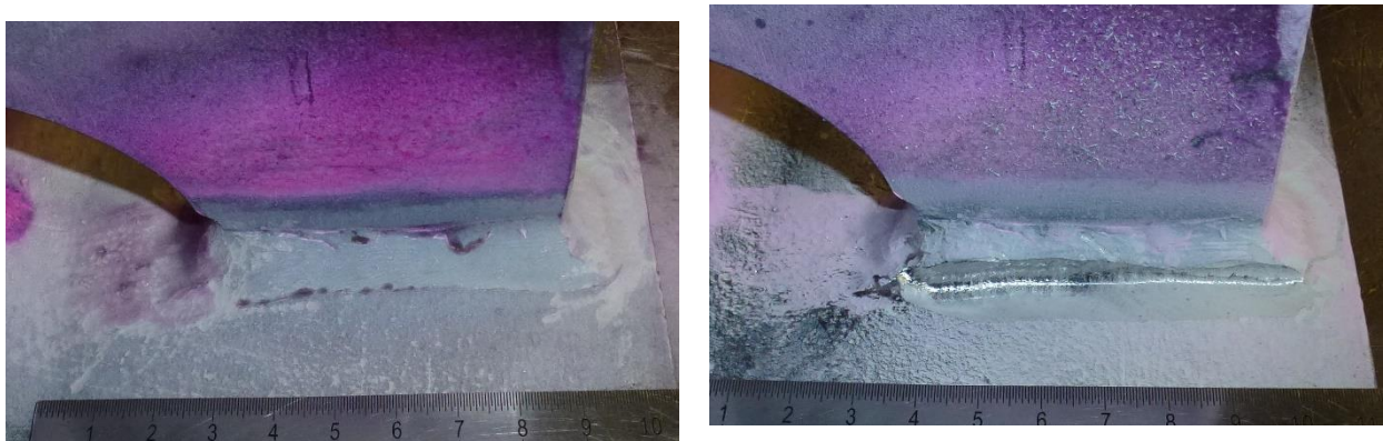
Abbildung 61: PT-Anzeige sowie ausgeschliffener Bereich, Tiefe 3,5 mm, Träger 1 - 1, 2L
