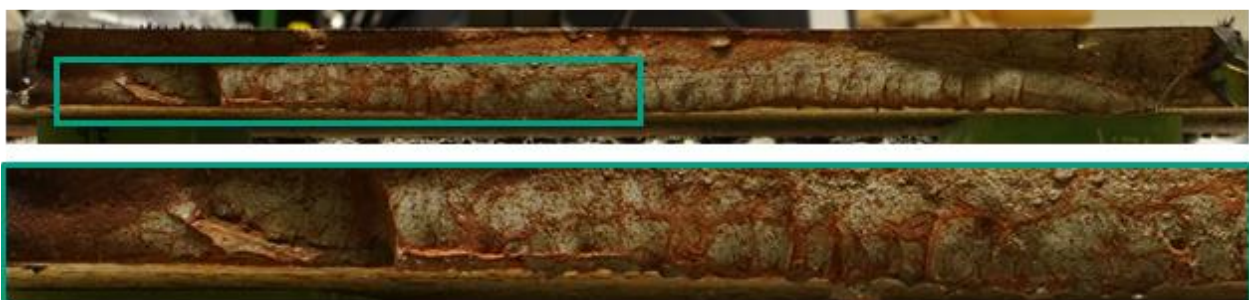
Abbildung 96: Bruchfläche Großbauteil Typ 3 - VL (linke Bildseite), HL (rechte Bildseite)
