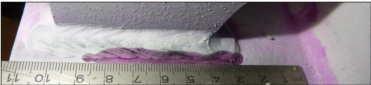
Abbildung 72: Linienförmige PT-Anzeige an Großbauteil Typ 1 – 5 S960QL
