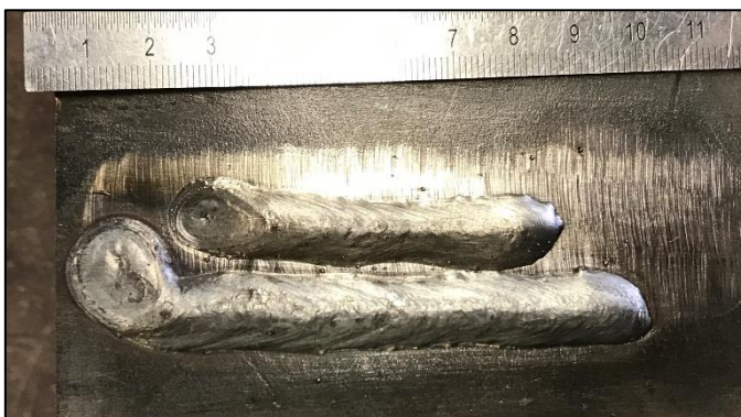
Abbildung 75: Ausbesserung von Einbrandkerben
