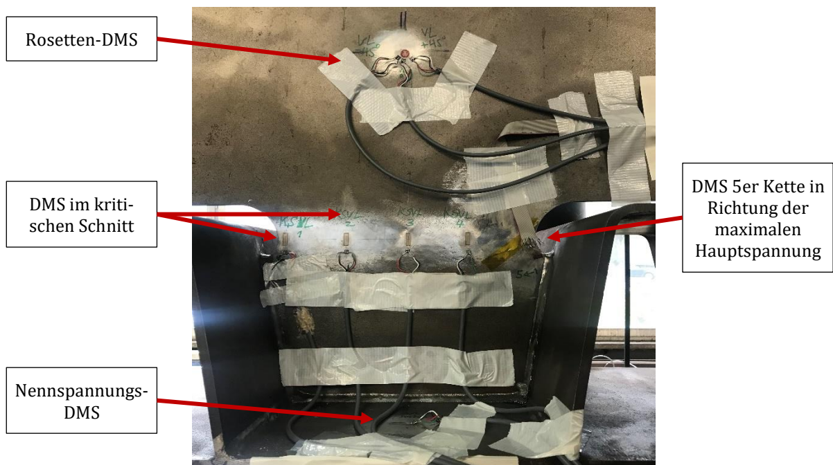
Abbildung 66: exemplarische Auswahl von DMS-Positionen an Großbauteil 3 - 1
