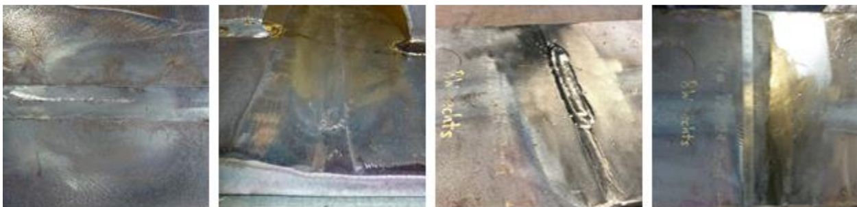
Abbildung 102: Großbauteil Typ 2, Zunderschicht nach dem Flammrichten, blechebenes Schleifen
