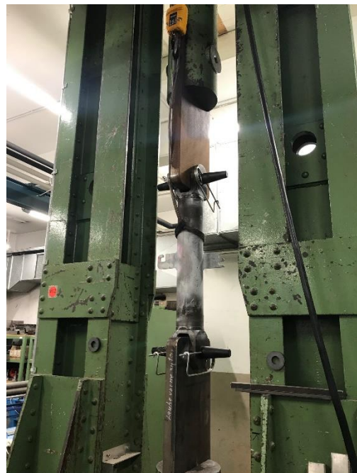
Abbildung 56: Versuchsaufbau Dauerschwingversuch an Großbauteil Typ 4 FGS 100 WV
