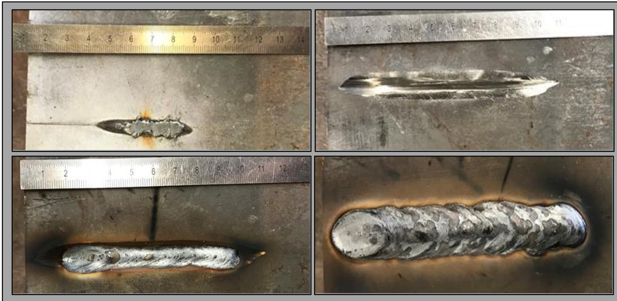
Abbildung 74: Schweißnahtvorbereitung und unterseitige Reparatur der Steife 5R 1 - 5 S960QL
